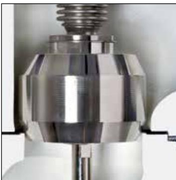
**6.** Ventilkegel mit zweiseitig konischer Dichtleiste aus gehärtetem Chromstahl 1.4021 oder gepanzert mit Stellite 6; Gehäusesitz gepanzert mit **Edelstahl** 1.4370 oder Stellite 21
