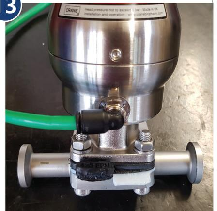
从执行机构上释放气压(仅适用于“NC”执行机构)
