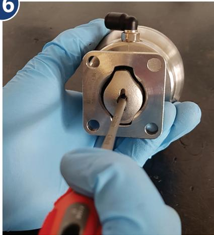
将螺丝刀啮合到主轴适配器插槽。
