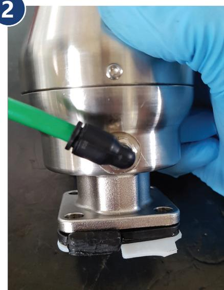
移除紧固件和阀门执行机构。
