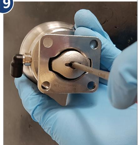
用平头螺丝刀将要更换的主轴适配器/压紧块子组件组装到执行机构的主轴上。
