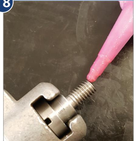
组装要更换的压紧块/主轴适配器子组件, 然后将乐泰 222 涂在螺纹上。
