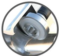
Der selbstausrichtende Sitz verhindert das Austreten von Medium und gewährleistet einen reproduzierbaren, wartungsfreien Betrieb. Seine durchdachte Konstruktion gestattet eine flexible, kontrollierte Bewegung des Ventils, das sich beim Schließen selbst nachstellen und an der Sitzöffnung ausrichten kann. Somit ist ein 100% dichter Abschluss gewährleistet.
