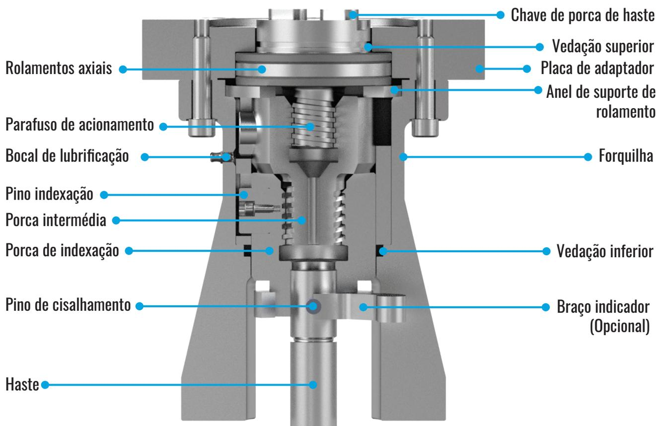
Para clientes com aplicações desafiantes, o desempenho de WEDGETORQUE™ de próxima geração com capacidade de desligamento estreito da pressão de trabalho fria total, em combinação com a capacidade de inversão de ciclo intermédio para curso parcial melhora a operabilidade, fiabilidade e gama de aplicações da solução Wedgeplug.
