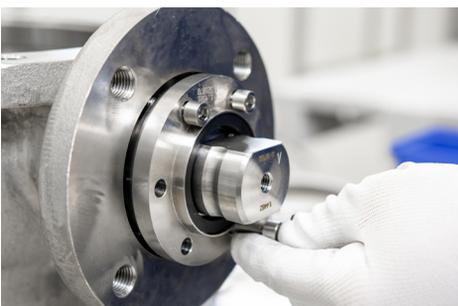
9.将填料压缩到装配压力;逐步将螺钉拧紧到第 9 或第 10 页表格中规定的扭矩。
