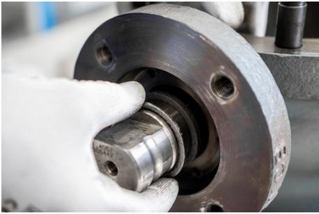
7.在压盖套 (#14) 和填料压盖 (#8) 的接触面上涂抹润滑脂, 然后将它们插入阀杆, 并将阀杆密封推入阀杆室深处。
