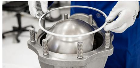
21. 将阀体 (#1) 和阀尾 (#2) 连接起来 (两侧的字母朝向相同), 按图 7 中所示的交叉模式安装并拧紧阀体螺柱螺母。
