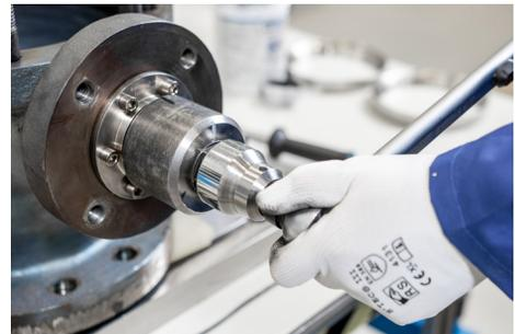
11.拆下填料压盖和压盖套。
