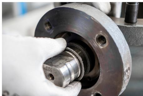
5. 在压盖套 (#14) 和填料压盖 (#8) 的接触面上涂抹润滑脂, 然后将它们插入阀杆, 并将阀杆密封推入阀杆室深处。
