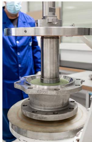
18. 将另一个密封环 (#40) 插入阀座“ A ”(#6) 上, 并将两者一起插入阀体 (#1), 再插入“ S 形 ”环 (#42) 上。在阀座 (#6) 的密封面上涂抹润滑脂。根据表 B 所示的数值, 以与盖子 (阀尾) 一侧相同的方式, 施加压力和轴向力来预压阀座密封。
