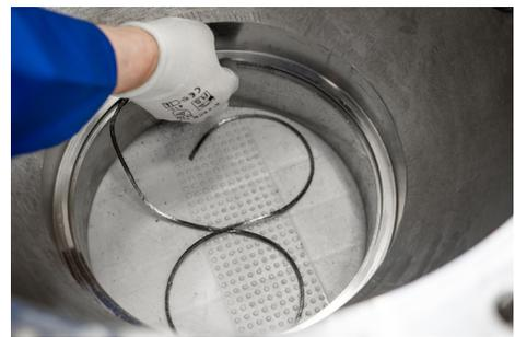
13. 将波形弹簧 (#41) 插入阀体部分 (#1)。
