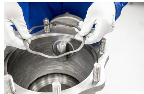
14. 将 S 形环 (#42) 插入阀体部分 (#1), 置于波形弹簧 (#41) 之上。保持 S 形环的方向, 如图 9 所示。
