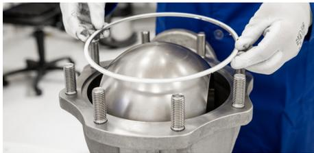
20. 将阀体 (#1) 和阀尾 (#2) 连接起来 (两侧的字母朝向相同), 按照图 7 所示的交叉模式安装并拧紧阀体螺柱螺母。
