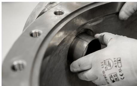
4. 在阀杆 (#4) 上安装一个“石墨填料环(厚)”和“扩散阻隔环(薄)”(#13)。
