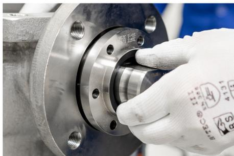
6. 在螺钉上涂抹“嘉实多 Optimol Paste TA 润滑脂”并将其插入填料压盖。用手稍稍拧紧。
