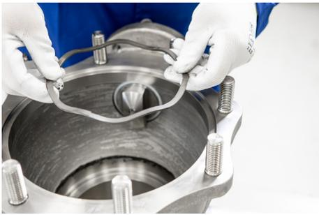
15. 将 S 形环 (#42) 插入阀体部分 (#1), 置于波形弹簧 (#41) 之上。保持 S 形环的方向, 如图 6 所示。
