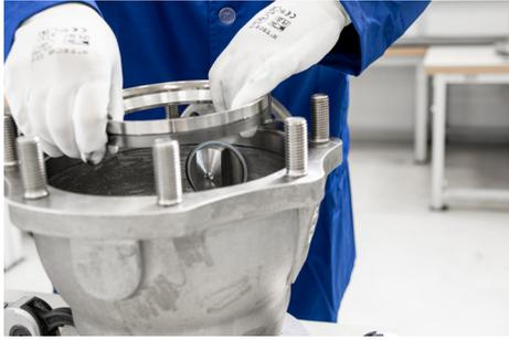
15. 将密封环 (#40) 插入阀座“B” (#6) 上, 并将两者一起插入阀盖 (或阀尾) (#2)。在阀座 (#6) 的密封面上涂抹润滑脂。根据表 B 所示的数值, 施加压力和轴向力来预压阀座密封。
