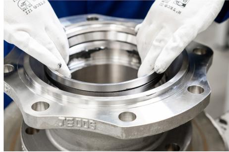
17. 使用压力机, 对阀座“ A ”(#6) 施加压力, 预压阀座密封。使用一个塑料垫片来保护阀座, 并施加特定的压力。如果没有压力机, 请联系 KROMBACH 以寻其他方法。
