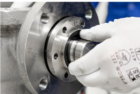
8.在螺钉 (#21) 上涂抹“嘉实多 Optimol Paste TA 润滑脂”并将其插入填料压盖。用手稍稍拧紧。
