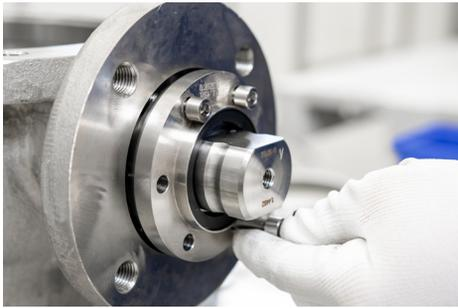
7. 将填料压缩到装配压力; 逐步将螺钉拧紧到第 9 或第 10 页表格中规定的扭矩。
