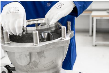
16. 将密封环 (#40) 插入阀座“B”(#6) 上, 并将两者一起插入阀盖 (或阀尾) (#2)。在阀座 (#6) 的密封面上涂抹润滑脂。根据表 B 所示的数值, 施加压力和轴向力来预压阀座密封。
