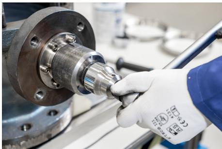
9. 拆下填料压盖和压盖衬管。
