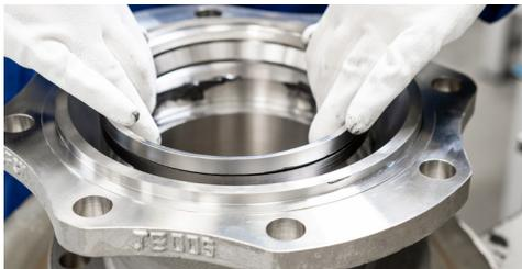
16. 使用压力机, 对阀座“B” (#6) 施加压力, 预压阀座密封。使用一个塑料垫片来保护阀座, 并施加特定的压力。如果没有压力机, 请联系 KROMBACH 以寻其他方法。
