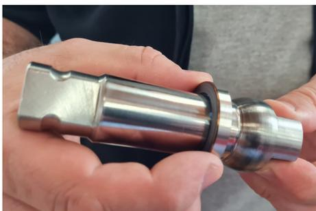
3. 将阀杆 (#4) 插入阀体空腔, 使 S2 阀杆密封 (#7) 在阀体埋头柱孔中就位。
