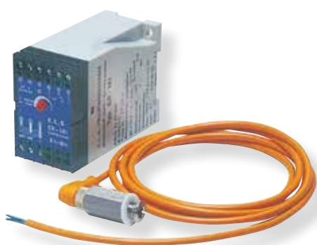
В случае разрыва диафрагмы перекачиваемая среда попадает в воздушную камеру, в результате чего срабатывает датчик. Затем датчик направляет электрический выходной сигнал на устройство мониторинга для оценки. Блок управления выключает подачу воздуха на воздушный клапан и тем самым прекращает работу насоса. Устанавливается по два датчика на насос (по одному на камеру).
