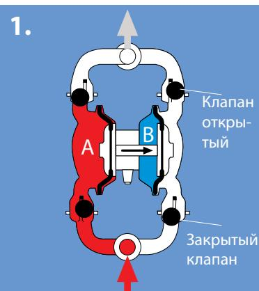
При запуске воздух под давлением в зоне В (действующий через присоединенные мембранны) понижает давление в камере жидкости А.
