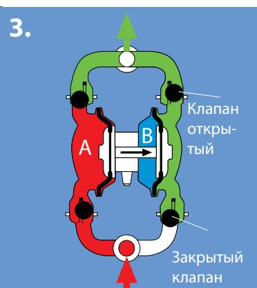
Процесс продолжается новым повышением давления в зоне В, вытесняющим среду из насоса и забирающим новую порцию среды в камеру А, где одновременно создается низкое давление.
