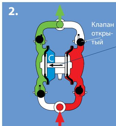
Воздух под давлением в воздушной зоне С действует на мембрану, вытесняя среду из насоса.
