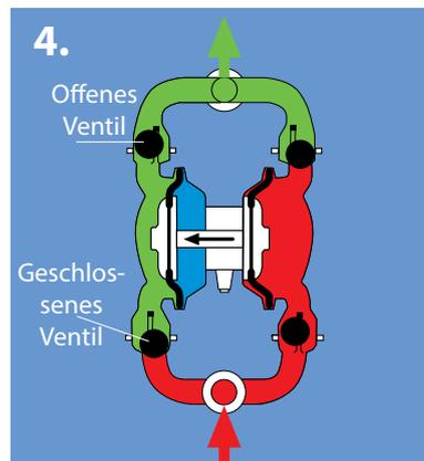
Der Zyklus wiederholt sich durch abwechselndes Erzeugen von Druck in den Bereichen B und C, während sich die Pumpe in Betrieb befindet.
