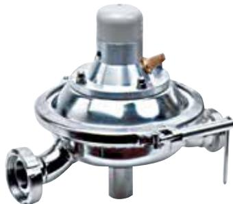
DEPA® Druckluft-Membranpumpen können mit einem aktiven Pulsationsdämpfer ausgestattet werden, der am Druckstutzen montiert ist. Dies reduziert die auftretende Pulsation auf ein Minimum.
