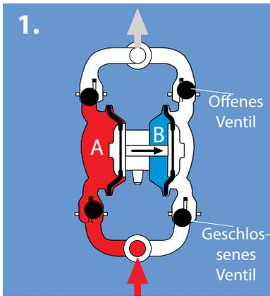
Beim Anfahren gelangt Druckluft in Bereich B (über die verbundenen Membranen), es wird in Kammer A Unterdruck erzeugt.
