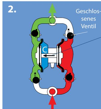
Druckluft im Bereich C wirkt auf die Membran, um das Produkt aus der Pumpe zu verdrängen.
