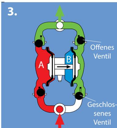
Im nächsten Schritt wird erneut Druck in Bereich B erzeugt; dieses Mal wird das Produkt aus der Pumpe verdrängt, während neues Produkt in Kammer A eingesaugt wird, indem ein Unterdruck erzeugt wird.
