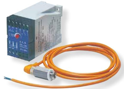
Bei einem Ausfall der Membran strömt das geförderte Medium in die Luftkammer und löst ein Signal am Sensor aus. Der Sensor sendet daraufhin ein elektrisches Signal an das Überwachungsgerät, das eine Auswertung des Signals vornimmt. Der Ausgang des Überwachungsgerätes kann dann zur Abschaltung der Pumpe genutzt werden.
