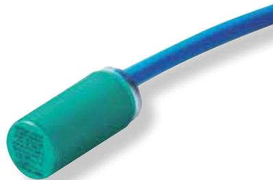
Der Hubzählersensor zählt jeden Zyklus der Membranbewegung. Durch Multiplikation der Zyklenanzahl mit dem Volumen der Förderkammer kann die druckseitige Förderleistung berechnet werden. Für Dosierungen bietet der Hubzähler eine genaue Messung und Regelung.
