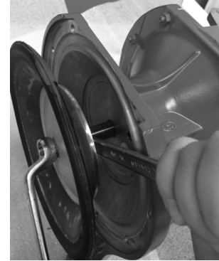
Bild 5: Kontern mit Maulschlüssel
