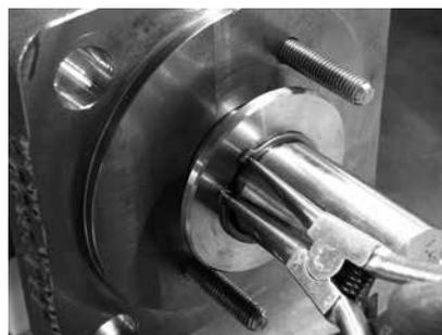
8. Установите на место шпильки верхней крышки (24), верхнюю крышку (17) и гайки верхней крышки (25). В случае опции для химической промышленности установите на место шпильки верхней крышки (24) и уплотнительное кольцо (35). Резьбовые шпильки (24) и контактные поверхности гаек (25) на сальниковом фланце необходимо смазать и затянуть с указанным крутящим моментом.
