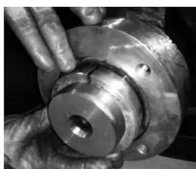
4. Установите крышку нижней опоры (6) с прокладкой крышки (7) со стороны корпуса (1) и затяните болты нижней опоры (21). 4. Крышку (6) и сальник крышки (7) необходимо установить на корпус (1) и затянуть винты крышки (21) с крутящим моментом из таблицы 12.7.
