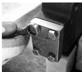
5. Проверьте зазор между диском (5) и подшипниками (11).
