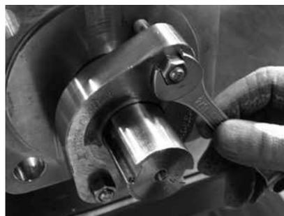
9. Установите на место резьбовую шпильку (22) и зафиксируйте диск (5) на штоке (10).
