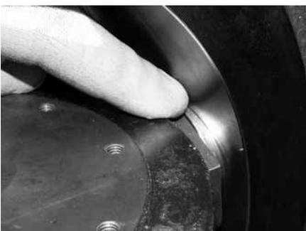
6. 在阀门关紧的过程中 (例如通过一个合适的手动齿轮箱驱动), 位于密封环压盖下的叠层密封环 (3) 自动调整定位, 实现夹紧密封。然后, 按照表 12.6 中提供的扭矩拧紧两个螺栓 (19), 然后稍微放松。必须将完全压入的包切换 30 次。
