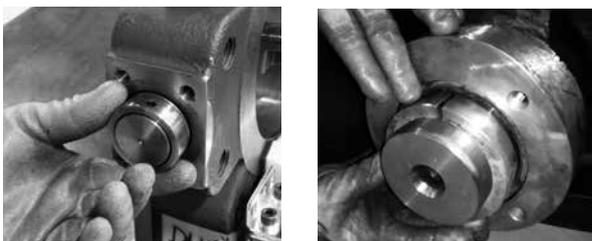
4. 带有阀盖垫圈 (7) 的阀盖 (6) 安装在阀体 (1) 上, 并拧紧阀盖螺钉 (21)。通过封盖 (7) 将盖子 (6) 安装在壳体 (1) 上, 并采用表 12.7 中的扭矩拧紧盖螺栓 (21)。
