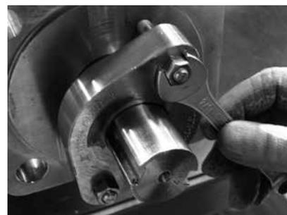
9. 重新安装螺纹销 (22), 将蝶板 (10) 固定在阀轴 (5) 上。
