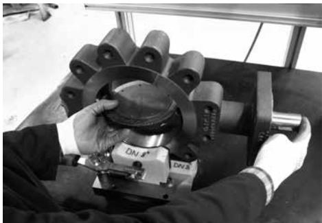
3. 重新安装止推环 (34) (如果允许), 阀轴护圈 (8) 和定位销 (9)。
